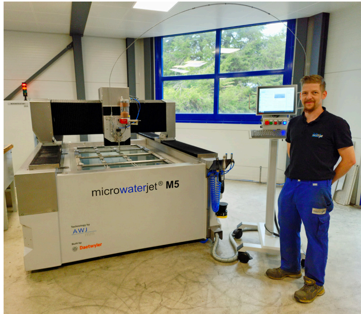
Malgré son format nettement plus élevé, la nouvelle machine M5 peut usiner des tôles allant jusqu'au format 2.000 x 1.000 mm avec la même précision que son prédécesseur beaucoup plus petit, la F4.
