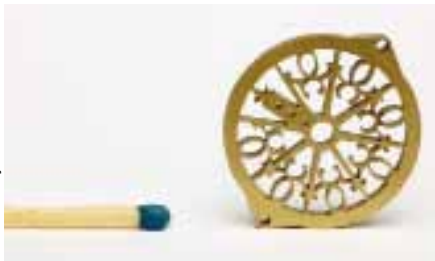
Microwaterjet: Musterteil für die Uhrenindustrie.
