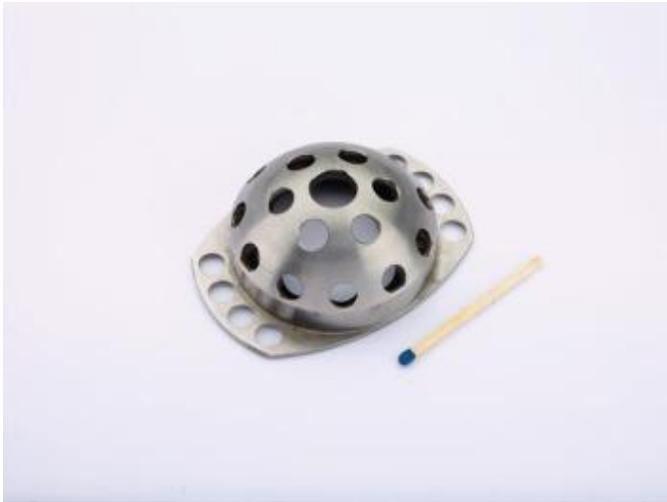
*Das Mikrowasserstrahlschneiden wird bereits erfolgreich in der Produktion von Implantaten angewendet. Durch ein neues Injektionsverfahren der Schweizer Microwaterjet können Oberflächenstrukturen nun auch mit Reinwasser bearbeitet werden.*
