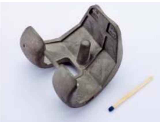
Mikrobearbeitung von Implantaten mit Wasser: Das hochpräzise Verfahren hat keinen Einfluss auf die thermische Spannung und die Gefügestruktur des Werkstoffs. Bilder: Microwaterjet
